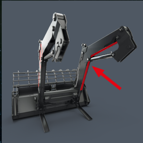
Τοποθέτηση σωλήνων για REAL 3 rd
